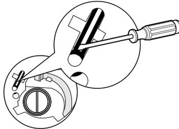
2. Föhren Sie das Gerät mit einem Schraubenzieher (oder einem anderen nicht scharfen Werkzeug) in die Zugschnur der Nottür ein
