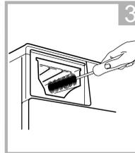
Entfernen Sie alle Rückstände mit einer weichen Bürste
